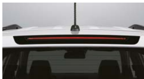
Wysoko zamontowane trzecie światło stop wykonane w technologii LED
