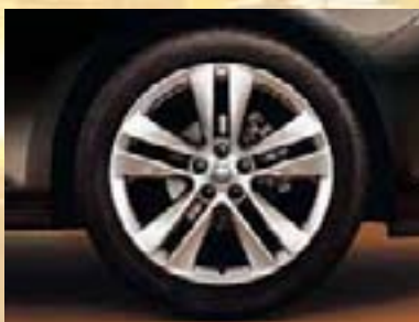
5 Obręcz ze stopów lekkich, 7,5 J x 18 i 8 J x 18, 5 podwójnych ramion, opony 225/45 R 18 lub 235/45 R 18 (PZV/PZJ).
