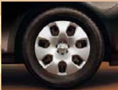
1 Stalowe obręcze kół z kołpakami 6,5 J x 16 i 7 J x 17, opony 205 (215)/60 R 16 lub 215 (225)/50 R 17 (PWM/PWP).
