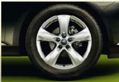
Felgi aluminiowe, 7 J x 17, 5-ramienne, opony 215 (225)/50 R 17 (PWX). Standard dla wersji Sport. Opcjonalne dla wersji Enjoy.
