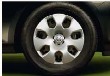
Stalowe felgi z kołpakami, 7 J x 17, opony 215 (225)/50 R 17 (PWP). Opcjonalne dla wersji Essentia i Enjoy.
