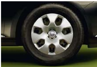
Stalowe felgi z kołpakami 6,5 J x 16, opony 205 (215)/60 R 16 (PWM). Standard dla wersji Essentia i Enjoy.
